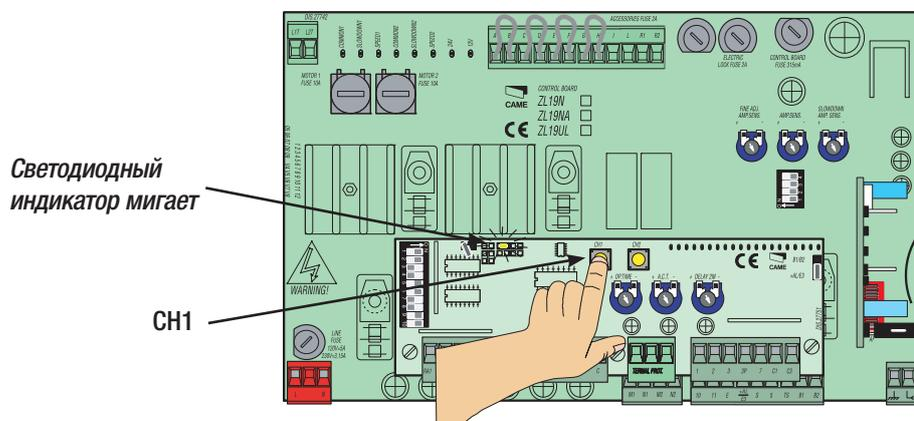
2) Нажмите кнопку программируемого передатчика. Если индикатор горит ровным светом, программирование прошло успешно.
