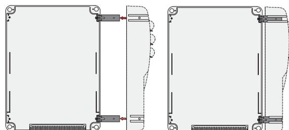
6) После выполнения всех необходимых подключений и регулировок закрепите крышку с помощью имеющихся саморезов.
