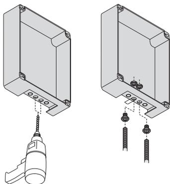
2) Рассверлите отверстия для гермовводов. Установите гермовводы с гофрированным шлангом для электрических кабелей.
